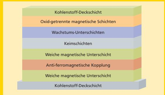
Abb. 4: Aufbau von Hitachi-Medien zur Senkrechtaufzeichnung.
